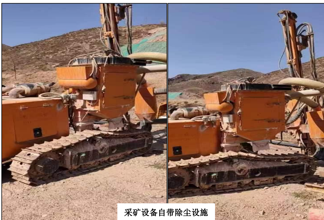
采矿设备自带除尘设施
