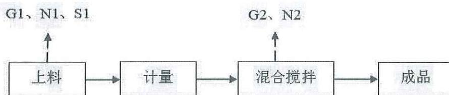
混凝土生产工艺流程图及排污节点图
